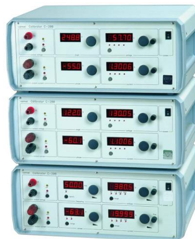
C233C trójfazowe symetryczne i asymetryczne źródło do 20A
