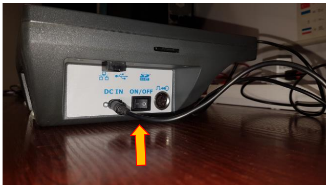
Podłącz przewód zasilający do TE30Lite i włącz urządzenie
