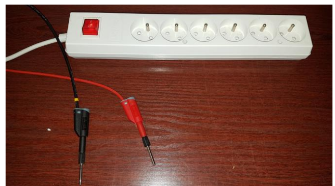
Przygotuj drugą stronę przewodu EA35 do podłączenia do mierzonego obwodu
