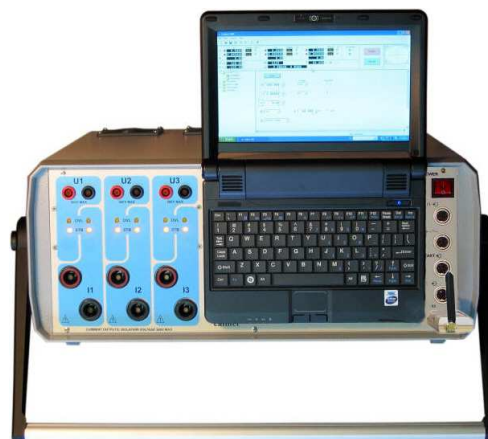
C300 mit Steuereinheit Netbook 10" angebracht mit Magneten und mit drahtloser Kommunikation
