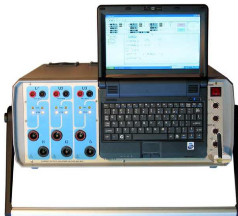
C300 avec l'option du driver Netbook 10" fixé à l'aide des aimants et avec communication sans fil
