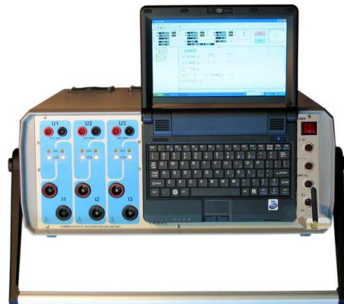
C300 com a opção do controlador Netbook 10" fixado através dos ímãs e com a comunicação sem fio
