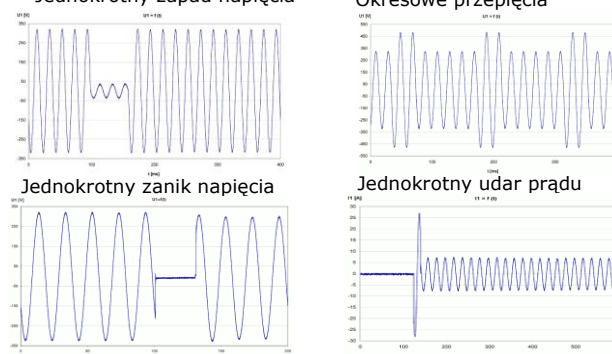
Oscylogramy sygnałów wyjściowych kalibratora C300B
