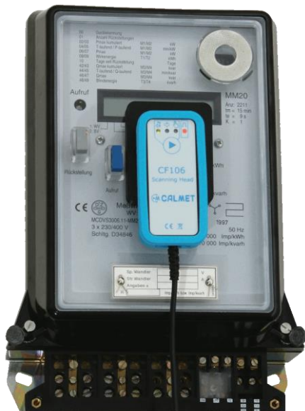
Test licznika z LED (fotogłowica zamocowana za pomocą samoprzylepnego rzepu)
