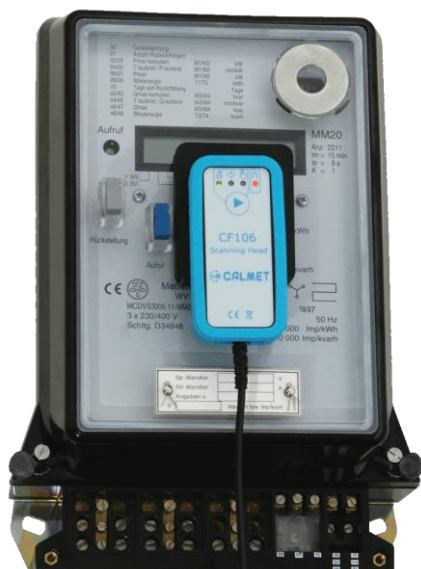
Test licznika z LED (fotogłówka zamocowana za pomocą adaptera EH01 i samoprzylepnego rzepu)
