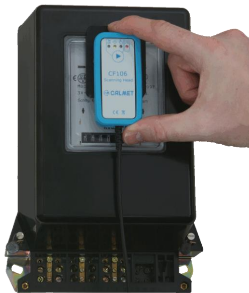
Szybki test licznika z rotorem („test z ręki” „z ręki” bez montażu do licznika)
