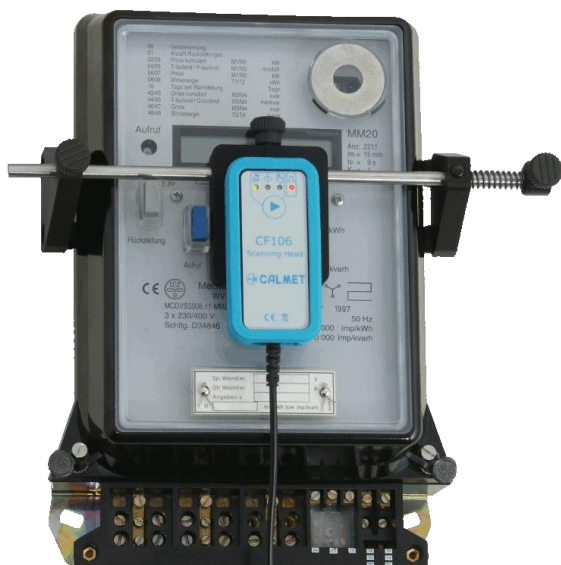
Test licznika z LED (fotogłówka zamocowana do licznika za pomocą uchwytu UCF106 – opcja CF106H)
