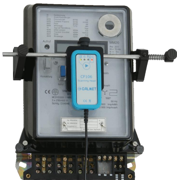
Test licznika z LED (fotogłowica zamocowana do licznika za pomocą uchwyty – opcja CF106H)
