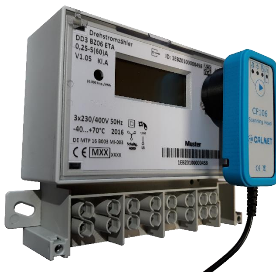
Test licznika z LED (fotogłówka zamocowana do licznika za pomocą magnetycznego adaptera EH02 – opcja CF106M)
