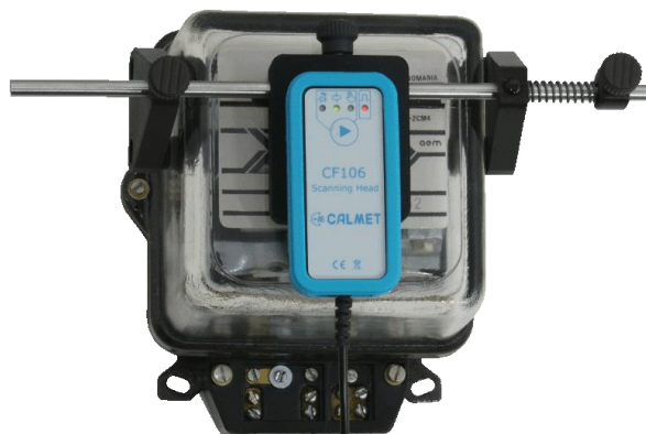
Test licznika z rotorem (fotogłowica zamocowana do licznika za pomocą uchwyty – opcja CF106H)
