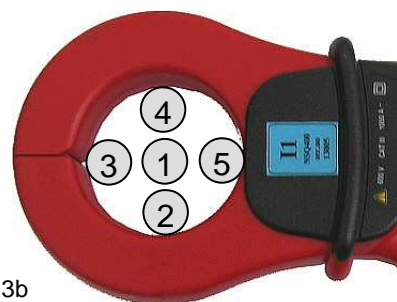
Rys. 3. Położenie cęgów 1000 A względem cewki ZW100/10A (3a) i przewodu z prądem (3b)
