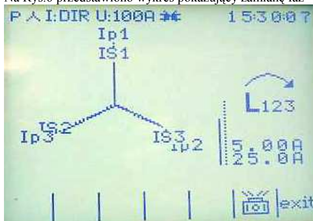
Rys. 6. Wykres wskazowy z zamienionymi fazami w uzwojeniach wtórnych I_{s2} i I_{s3} przekładników prądowych
