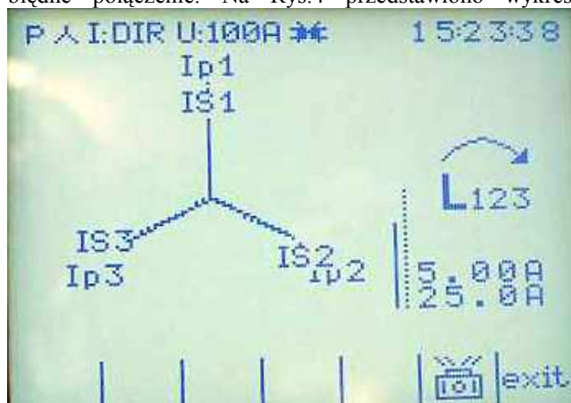
Rys. 4. Wykres wskazowy prawidłowego podłączenia przekładników prądowych
