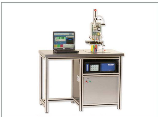
Rys.4. Widok stacjonarnej jednostanowiskowej stacji wzorcowiczej typu LS3
