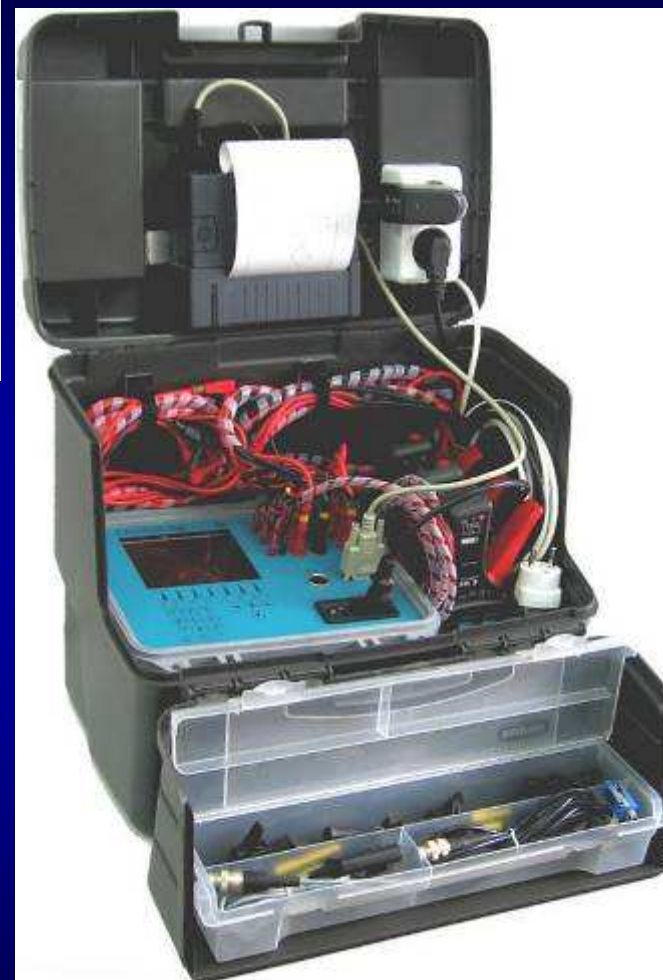
Tester liczników typu Calport 100A klasa 0,1 i 0,2 z wyposażeniem
