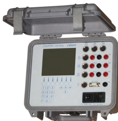
Rys. 4. Widok wejść testera liczników i przekładników
