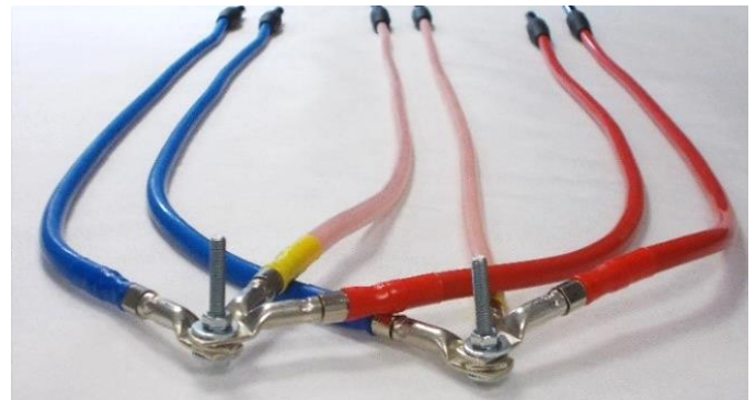
Połączenie równoległe przewodów (360A)
